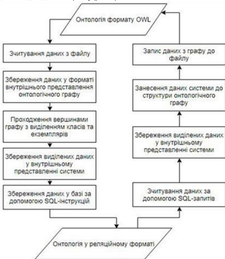
Рис. 6. Схема алгоритму відображення онтології з реляційної моделі до OWL-файлу
