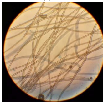
Рисунок 2 – Мікроскопія з хлорцинкйодом волокнистого складу зразка №2
