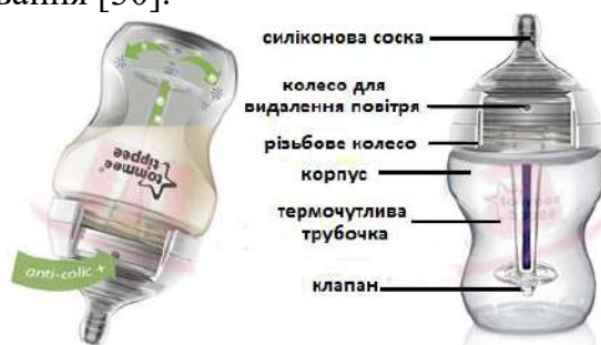
Рис. 6. Антиколікова система пляшки Tommee Tipree серія Closer to Nature Anti-Colic Plus
