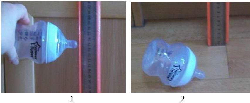
Рис. 13. Фотографічне зображення процесу перевірки міцності на удар пляшки для годування немовлят ТМ Tommee Tippee Closer to nature: 1 – до випробувань; 2 – після випробувань
