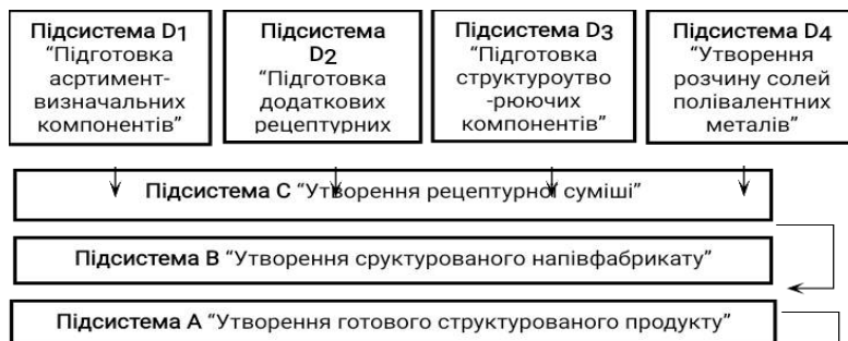
Рис. 1. Блок-схема технологічного процесу виробництва структурованих продуктів
