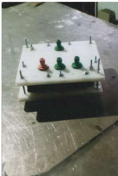
Рис. 3. Секція електролізера (фото)
