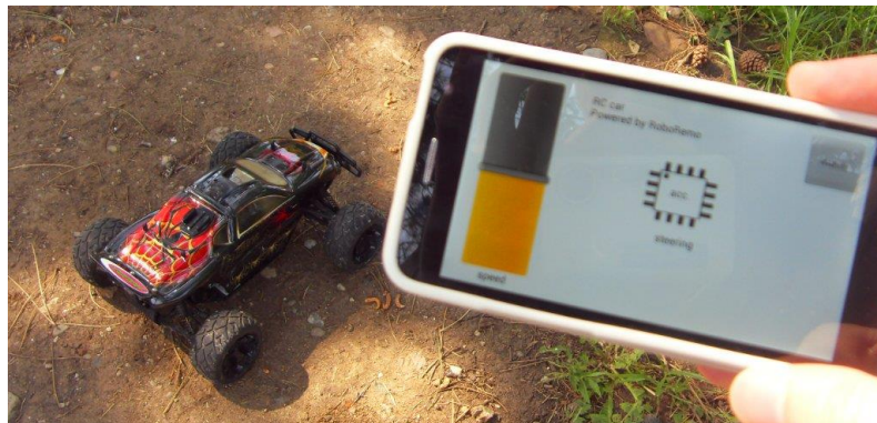
Рисунок 2.1. Приклад створення машинки віддаленого керування з використанням Bluetooth RC Receiver та RoboRemo
