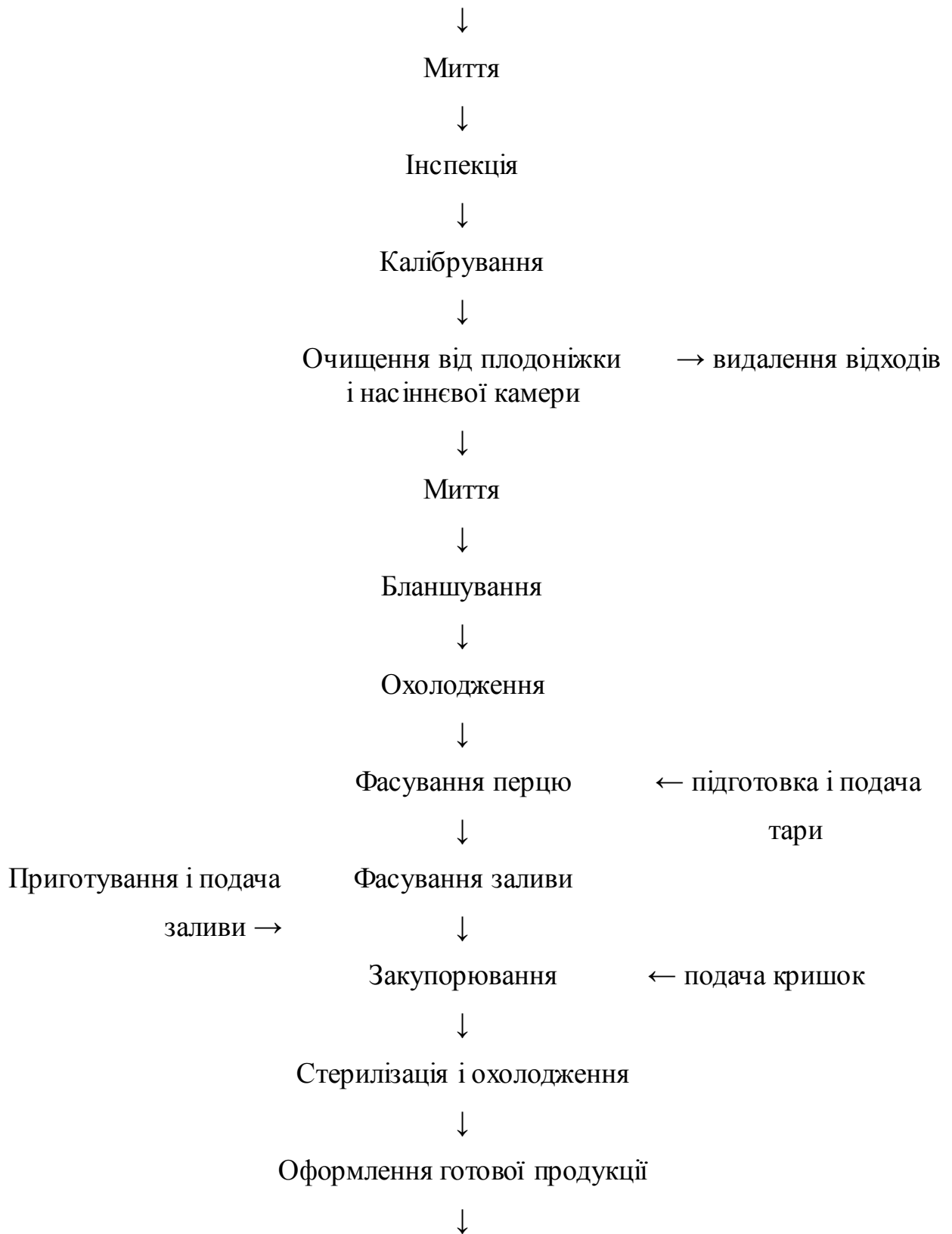
Рисунок 2.2 - Технологічна схема виробництва консервів «Перець солодкий натуральний»
