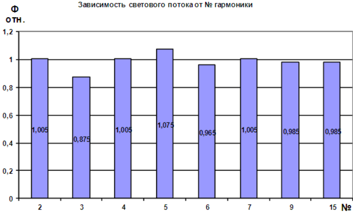
Рисунок 1 – Зависимость светового потока светодиодов «ACRICHE» от коэффициента искажения синусоидальности напряжения гармонической составляющей
