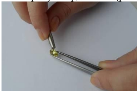
Рисунок 3 – Визначення твердості об'єкта дослідження
