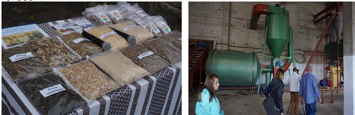
Рис. Лінія з виробництва паливних пелет і брикетів з соломи, залишків соняшника та тирси у Бугринській ОТГ на Рівненщині Джерело: дані [210].
