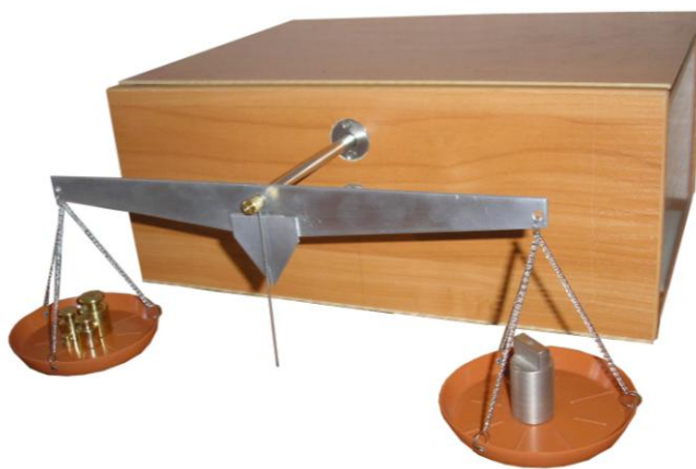
Мал. 1 Експериментальна установка для зважування металевого тіла
